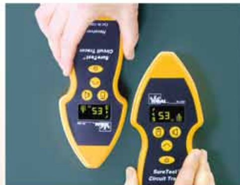
Revolutionäre Technologie beim Modell 956 und 958 lässt die Anzeige in 90°-Schritten drehen, so dass Sie immer eine direkt ablesbare Ergebnisanzeige bekommen, die nie auf dem Kopf steht.
