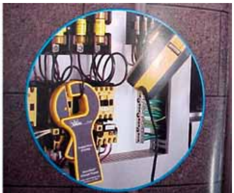
Die Induktions-Zange ermöglicht die Einspeisung eines Signals auf das Kabel ohne direkte Kontaktmöglichkeit (z. B. Kabelkanälen, Kabelschacht)
