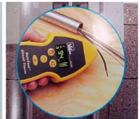
Einzelne Drähte können sortiert, offene Adern und Kurzschlüsse können einfach lokalisiert werden.
